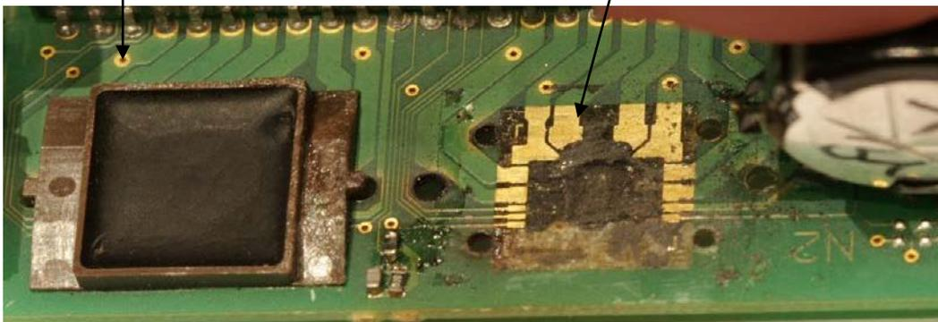
En la otra cara de la placa tiene un pequeño radiador , que debeis desoldar antes y queda así
