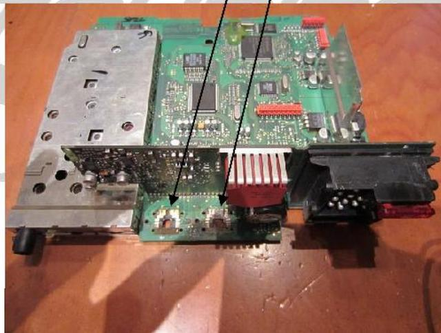
Son así primero, después le quitais el recubrimiento epoxi haciendo palanca con un destornillador y con cuidado ..... queda así
